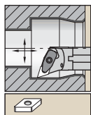
Mango de acero con refrigeración interior.
